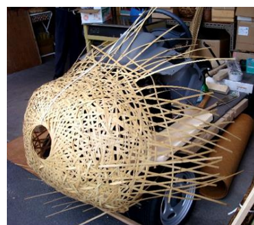
車体を竹で編む(東洋竹工株式会社) https://www.toyo-bamboo.com/bamgoo.html
